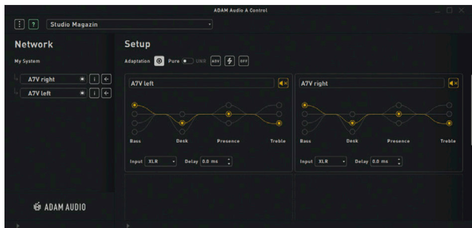
Abbildung 1 – A7V Backplate-Modus. Die Software-GUI ist ein Abbild der Bedienelemente auf der Rückseite des Monitors
