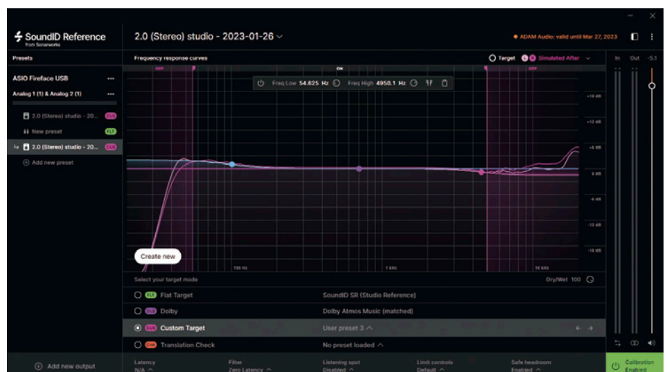
Abbildung 5 – von SoundID errechnetes Ergebnis der Korrektur-Entzerrung unter Berücksichtigung der Zielkurve
