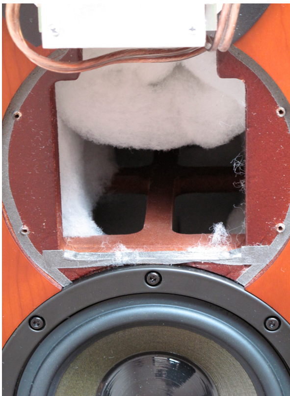
Der obere der beiden Konustreiber arbeitet bis zu einer Trennfrequenz von 800Hz und übergibt dann an den X-ART-Mitteltöner, der sich dann bei 2.800Hz aus dem Geschehen zurückzieht.
